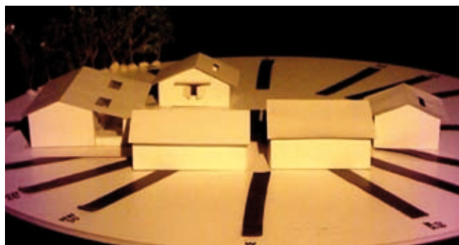
Imagen 6. Utilización de masa térmica al poniente, como estrategia de transferencia de calor por las noches.
