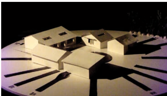
Imagen 4. Colocación de contraventanas al Oeste, en equinoccio de primavera, 16: 00 hrs. toma Sur.
